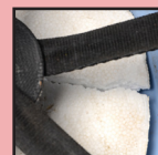
Bruch im Schaumteil
