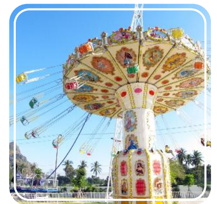
Центробежната сила удължава рамената на въртележката, след като тя започне да се върти
